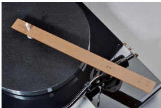
LP9.1似乎在出厂的时候调好这个距离了，小孔与唱臂柱中心孔几乎重叠，看来无需调整唱臂的位置，真是太贴心了
