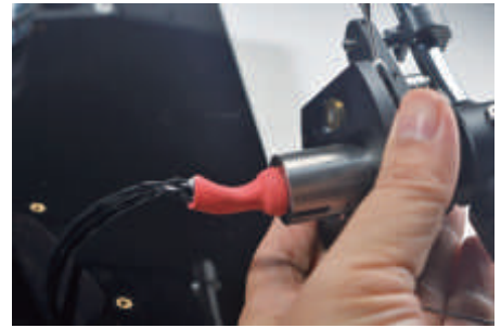
01. 把底座的5针接口连接到唱臂的接口，过程很简单，对准针位插入即可。
