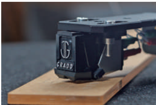
02. 将唱头移到规尺上，看看针尖是否可以到达17.4这个点，不过运气不错，目测针尖基本上位于这个点。
