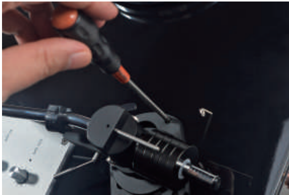
02. 将整支唱臂固定在底座上，对准螺丝位，拧好4颗螺丝。师傅教导，先不要拧紧，方便后面调整臂距什么的。
