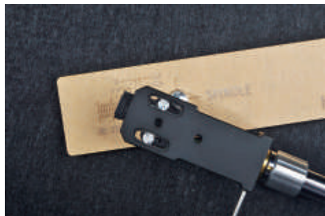
01. 固定好规尺，另一头最好对准唱臂柱中心。
