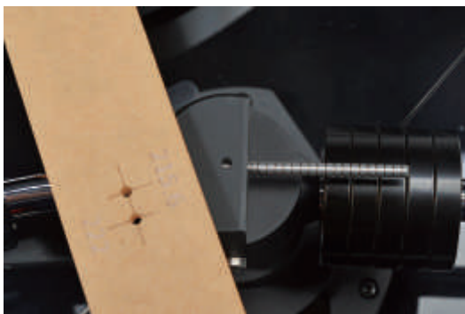
02. 规尺的另一端标示215.6这个小孔对准唱臂柱中心孔，看看是否重叠，否则就要调整唱臂的位置。
